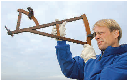
Raffinierter Strahlengang: Sonnenlicht fällt von rücklings auf einen Horizontschlitz
