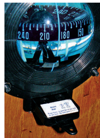
Kompensationseinrichtung an einem Yachtkompass: Mit vier paarweise zu verstellenden Magneten gegen die Ablenkung
