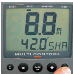
Korrekturwert für Anzeige von Kartentiefe oder Wasser unterm Kiel.
