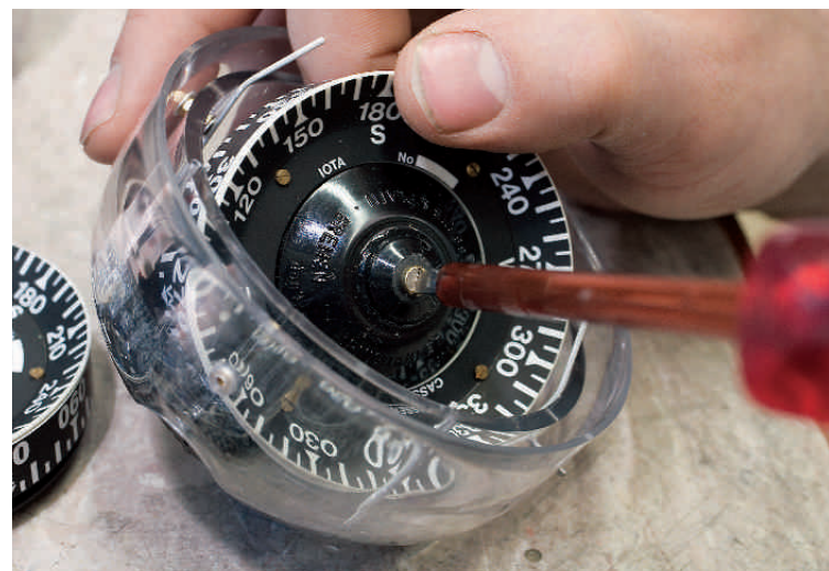
Die Pinne wird in die Kompassrose geschraubt. Trotz vieler technischer Hilfsmittel erfolgt die Montage in Handarbeit
