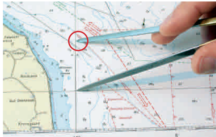
Die Zirkelspanne vom selben Breitenkreis aus auf einem Längenkreis antragen, der in der Nähe der Position liegt (Kreis)
