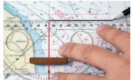
Mit dem Kursdreieck eine waagrechte Linie zeichnen, die etwas über die ungefähre Position hinausreicht
