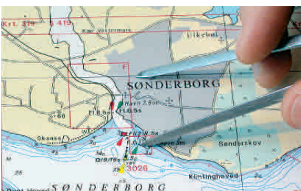
Den Abstand der zu bestimmenden Position zum nächstgelegenen Breitenkreis in den Zirkel nehmen
