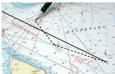
Die GPS-Positionen in gleichen Zeitabständen eintragen. So kann nicht nur die Abweichung, sondern auch eine Geschwindigkeitsänderung leichter erkannt werden
