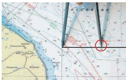
Die Zirkelspanne auf die Hilfslinie übertragen und markieren. Der Ort ist gefunden
