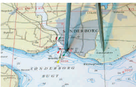
Den Abstand zwischen Position und nächstem Längenkreis in den Zirkel nehmen
