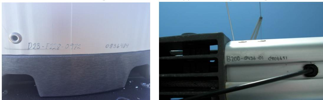
Notiert die Mast- und Baumnummer eures Riggs (Foto Vorseite Gotthardt/Seldén), dann kann Seldén alle Einzelteile des Riggs sofort eurem Mast zuordnen. Das ist nicht nur bei Mastbruch, sondern auch dann besonders hilfreich, wenn du Austausch- oder Ersatzteile brauchst.
