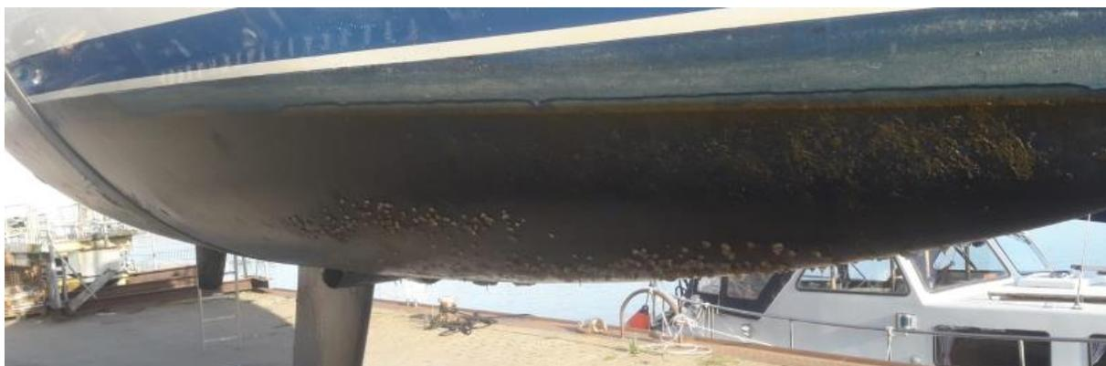
Ein paar Tage bevor wir zu Sjælland Rund ablegen, geht's in die Werft, der Dampfer wird gekrant. Das Ruderspiel muss beseitigt werden. Den job erledigen die Dschunxx auch gut, aber was ist mit dem Unterwasserschiff? Der gesamte Unterwasserbereich wurde im Winter komplett abgezogen, neu aufgebaut und jetzt so viele Pocken? So schlimm war's noch nie!
