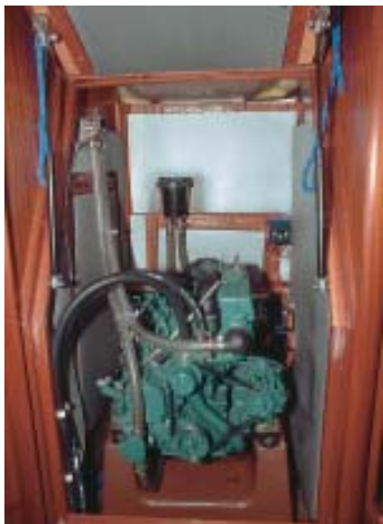
Der Niedergang wird für Maschinenarbeiten in einem Stück gasfederunterstützt hochgeklappt.
